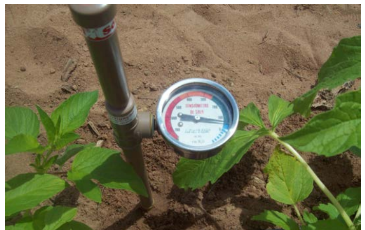
Figura 2. Tensiômetro com escala graduada para monitorar a irrigação
